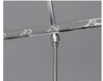
Detailansicht: Das Kugelgelenk für die Neigung des Bikes um bis zu 30 Grad.
