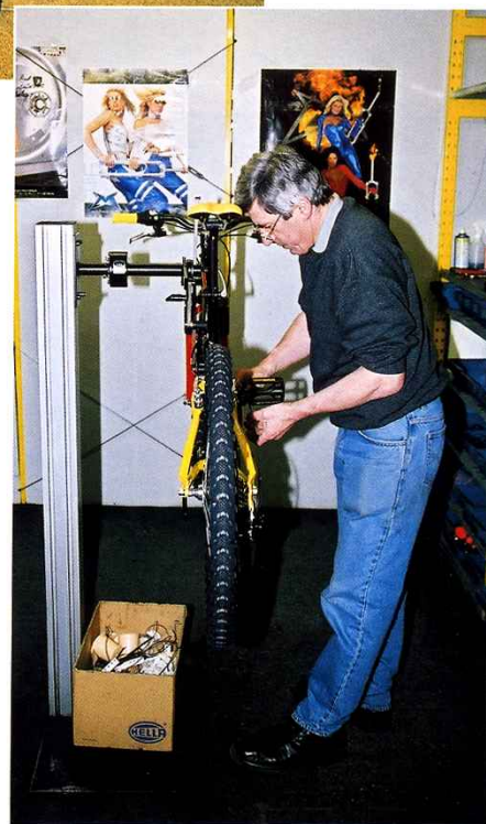
Einzelplatzmontage von Fahrrädern bei Strauch.
